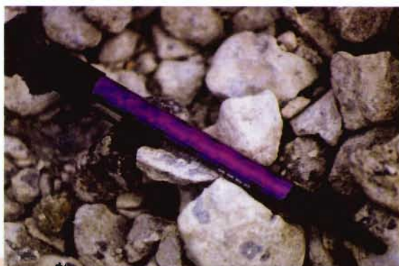
Foto 4: Agregado de reciclagem de concreto da Superfos em Copenhague, Dinamarca
