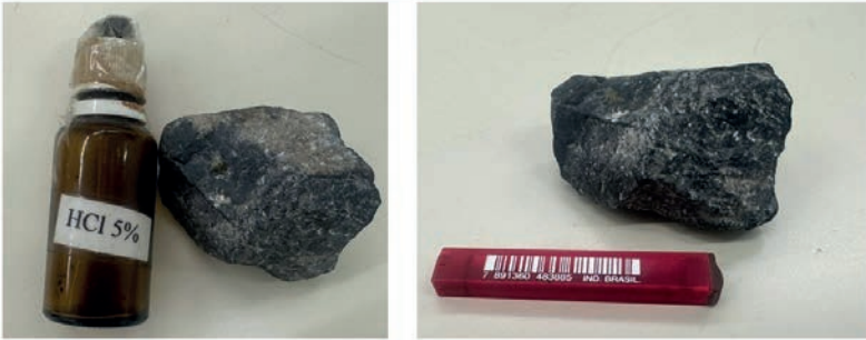
Descrição da Amostra de base: Rocha de coloração cinza, algumas bandas milimétricas de cor branca, finamente granulares, rocha compacta e reagente a HCl 5%.
