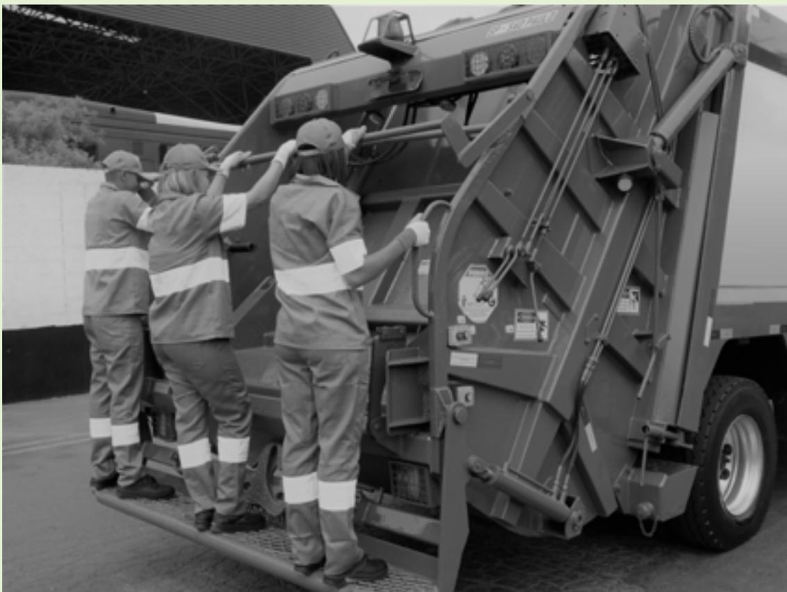
Com a norma da ABLP, a plataforma operacional e balaústre dos compactadores são alguns dos itens que passam a ter diretrizes específicas de fabricação para garantir ainda mais segurança aos trabalhadores.
