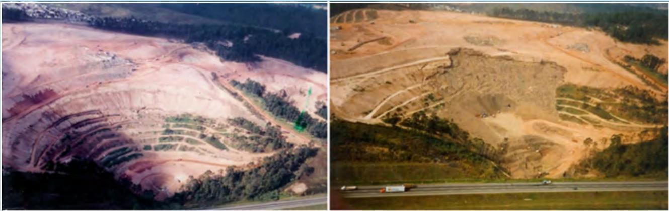
Foto 2. Aterro sanitário em situação anterior a ruptura e após o evento de 1991 (acervo Geotech).
