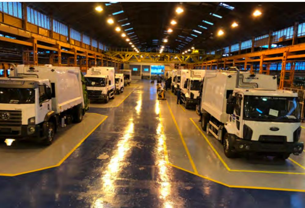
Fase final da montagem, com as caixas compactadoras acopladas ao chassi do caminhão.
