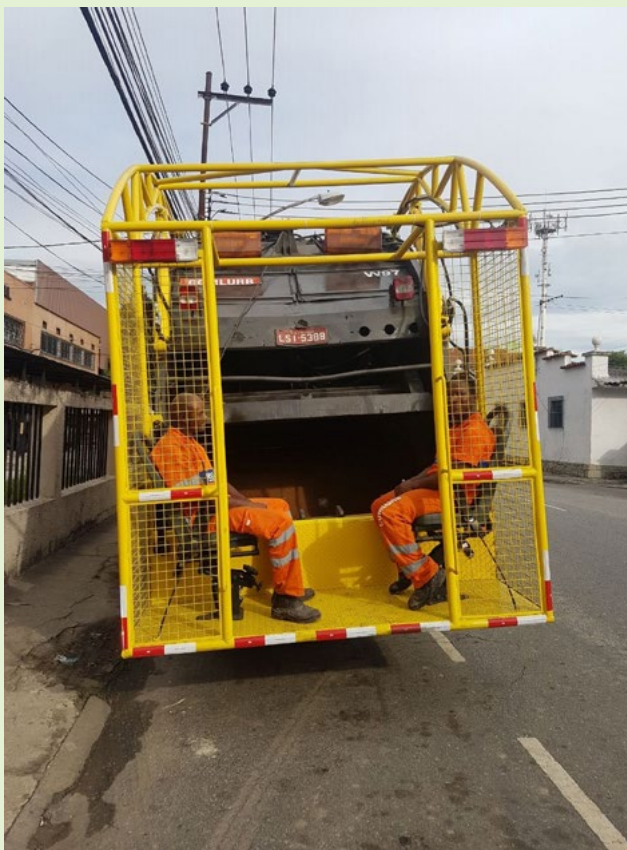
A “célula de segurança” tem a aparência de uma gaiola.
