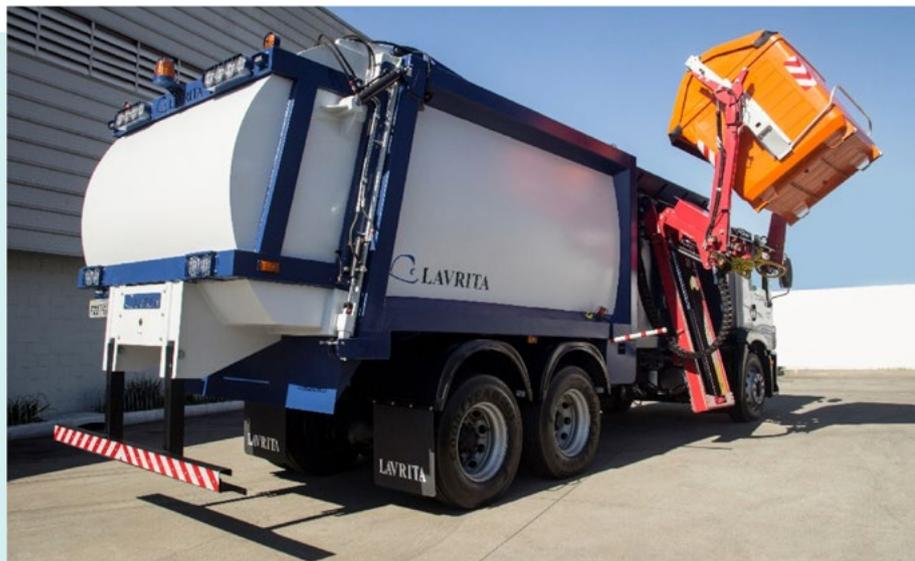
O compactador de carga lateral e os contentores metálicos desenvolvidos pela Lavrita
