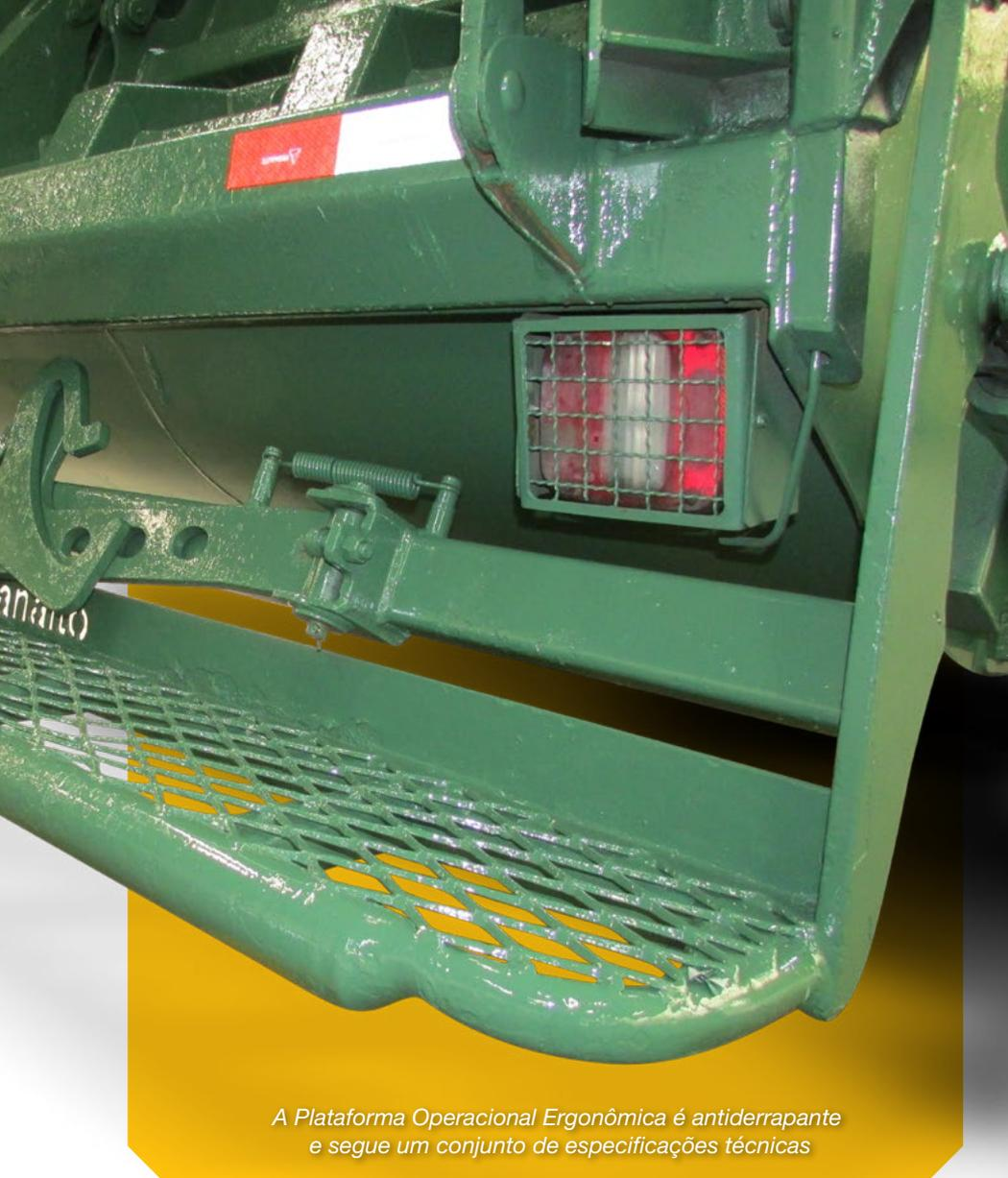
*A Plataforma Operacional Ergonômica é antiderrapante e segue um conjunto de especificações técnicas*
