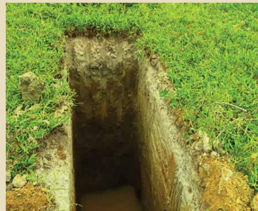
Figura 3 – Nível do freático encontrado durante a realização de sondagem com retroescavadeira.
