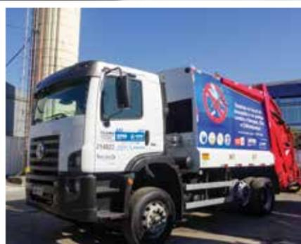
dirigibilidade. Batizado de ELC (Eletronic Levelling Control), o sistema altera a suspensão convencional (feixe de mola) para pneumática, desenvolvido pela Knorr-Bremse na Europa e adaptado para a realidade brasileira.
