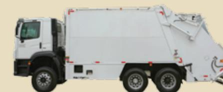
Além da capacidade de coletar maior volume e peso de materiais na mesma viagem, o compactador proporciona uma ergonomia mais adequada para os operadores. O diretor comercial da Cimas, Fábio Gomes, cita o tempo de operação como outra grande vantagem do uso do compactador. "Como a descarga é mecânica, o serviço chega a diminuir de 30 para cinco minutos em relação ao caminhão baú", conclui.
