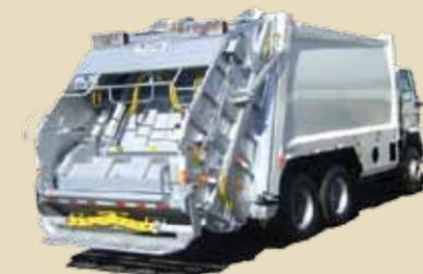
O compactador reduz o volume do lixo por compressão. "Depende muito da consistência do lixo, mas, em geral, o veículo é capaz de compactá-lo até o limite de 600 a 700 kg/m<sup>3</sup>. Então, um caminhão de 10m<sup>3</sup> tem a capacidade de transportar até 7 toneladas de lixo", afirma Marcos Pacífico Homem, diretor comercial da Planalto, empresa que também oferece equipamentos para todo o Brasil.
