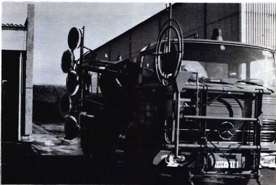
*Equipamento de limpeza de túneis. As escovas e aspersores movem-se hidraulicamente.*
