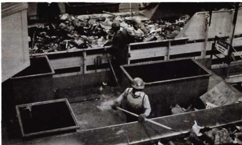
*Esteiras de triagem das duas linhas paralelas da usina de processamento de lixo do Sistema Americology, montada pela American Can, em Milwaukee.*
