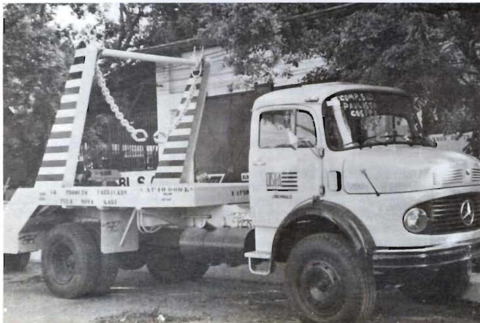
Para movimentar coletores com resíduos de alcatrão, benzol, creosoto, lama de óxido de ferro, escória, entulhos de refratários, sucata de ferro, pontas, carepa, lingote, blocos de escória e todos os outros tipos de resíduos industriais a COSIPA optou pelo Poli-Guindaste “MULTIBEND”, modelo KPG-100/250-AP-SHA para 10 toneladas e 10 m3 de capacidade.
