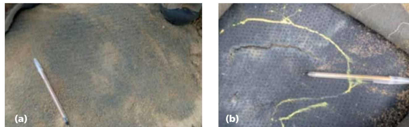
**Figura 6.** Rasgo localizado em inspeção com LGF em geomembrana embaixo de geotêxtil não-tecido e coberto com uma camada de 30cm de solo arenoso: (a) visão do liner depois de escavado e exposto com geotêxtil intacto. (b) Rasgo na geomembrana localizado com o método dipolo em solo.
