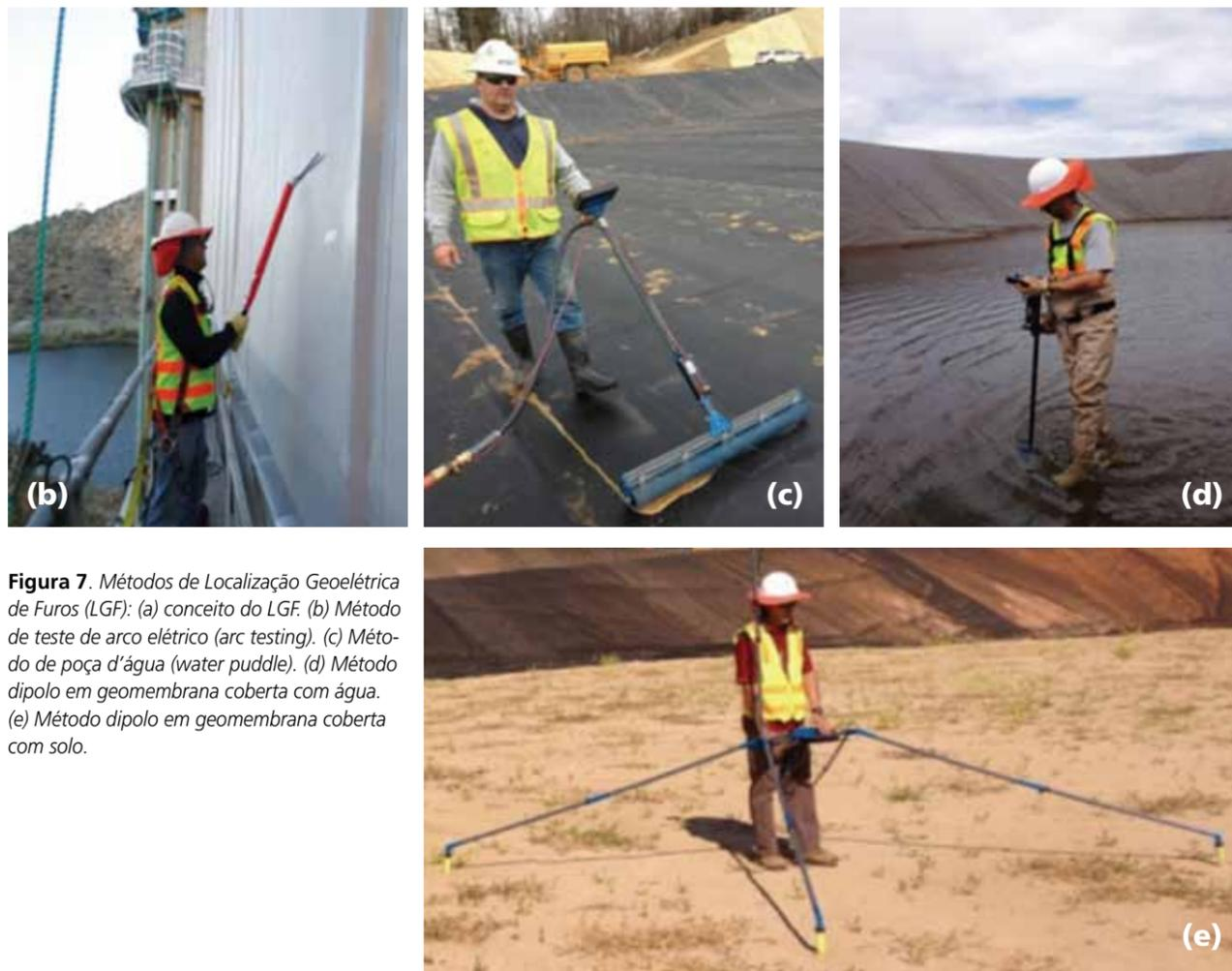
**Figura 7.** Métodos de Localização Geométrica de Furos (LGF): (a) conceito do LGF. (b) Método de teste de arco elétrico (arc testing). (c) Método de poça d'água (water puddle). (d) Método dipolo em geomembrana coberta com água. (e) Método dipolo em geomembrana coberta com solo.
