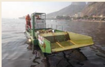
O Ecoboat, lançado pela Koleta Ambiental, é uma iniciativa pioneira, com o objetivo principal de atuar na retirada de lixo flutuante e vegetação aquática excedente. O equipamento foi projetado para recolher o resíduo sólido flutuante, que não é estático, pois navega de acordo com as correntes
