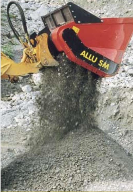
Para peneirar, triturar, pulverizar, fazer aeração, combinar, misturar, separar, alimentar e carregar diferentes tipos de materiais em uma única operação.
