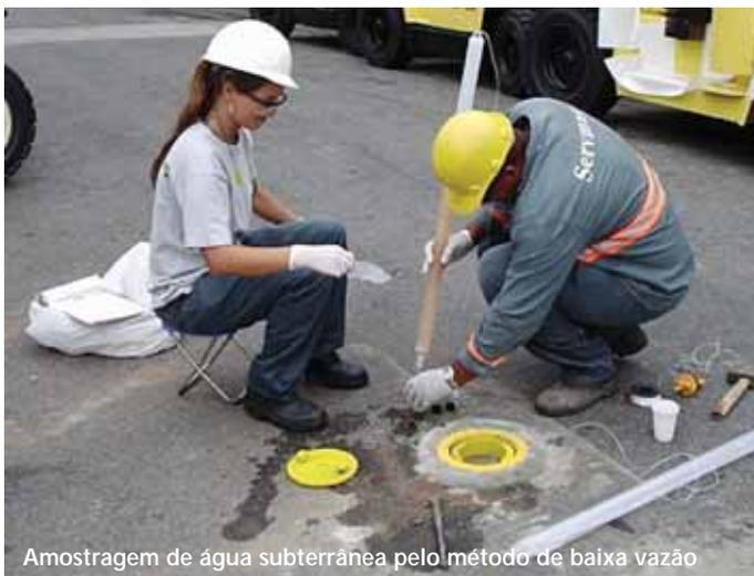
Amostragem de água subterrânea pelo método de baixa vazão
