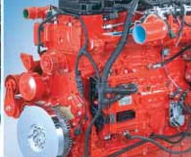
Motor Cummins eletrônico com 220cv
