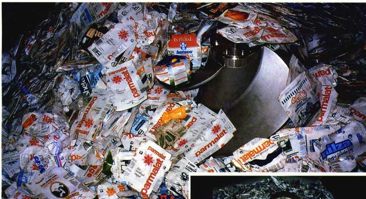
**Figura 1:** Hidrapulper em alta consistência antes da desagregação
