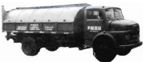
Caçamba coletora de lixo, tipo Prefeitura (convencional) apresentadas em 3 tamanhos de volume, com basculamento traseiro.
