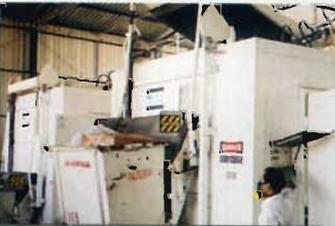
A CAVO foi pioneira no Brasil ao utilizar processos anti-poluentes para a desinfecção do lixo hospitalar com tecnologia de ponta. Os processos permitem a redução do volume do resíduo em até 80%, sem emitir gases tóxicos ou efluentes líquidos.
