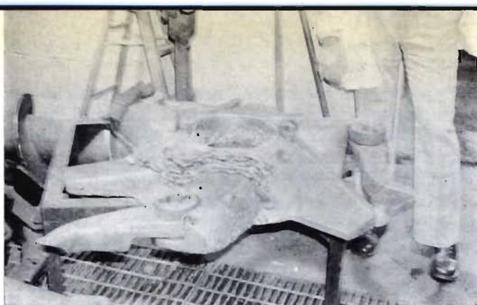
Dispositivo cortador dos "Hydro pulpers" que reduz o lixo a uma "sopa" com 3,5% de sólidos em suspensão, com menos de polegada de diâmetro.
