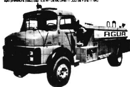
TANQUE D'ÁGUA KABI C/MOTO-BOMBA PRÓPRIO para lavagem, rega, etc. e combate a incêndios — PREF. MUN. CACHOEIRO DO ITAPEMIRIM — ES
