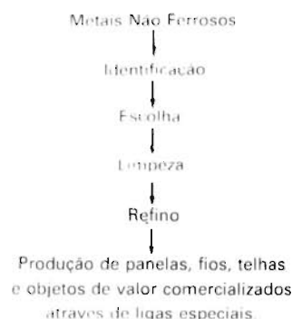
Fluxograma 9 - Reciclagem de metais não ferrosos para finalidade nobre (6).
