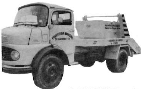
Mod. KPG 60/140-SM-V3 — cap. 6 ton volume até 2,5 m 3
