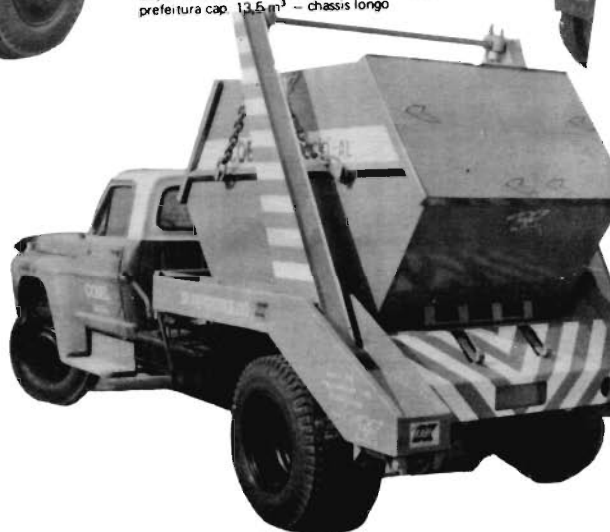
Caçamba basculante mod. KCLP - 135 - tipo prefeitura cap. 13,5 m 3 - chassis longo
