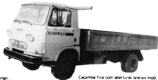
Caçamba fixa com aberturas laterais mod. KC - 35 - cap. 3,5 m 3
