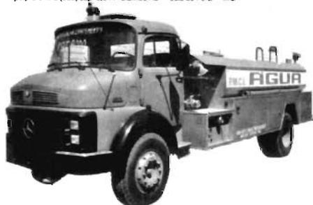
TANQUE D'ÁGUA KABI COM MOTO-BOMBA PRÓPRIO para lavagem, rega, etc. e combate a incêndios — PREF. MUN. CACHOEIRO DO ITAPEMIRIM — ES
