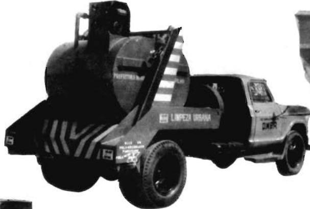
POLI-QUINDASTE KABI-MULTI-CAÇAMBAS com tanque d'água e moto-bomba
