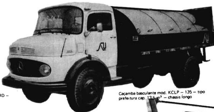
Caçamba basculante mod. KCLP - 135 - tipo prefeitura cap. 12,5 m<sup>3</sup> - chassis longo
