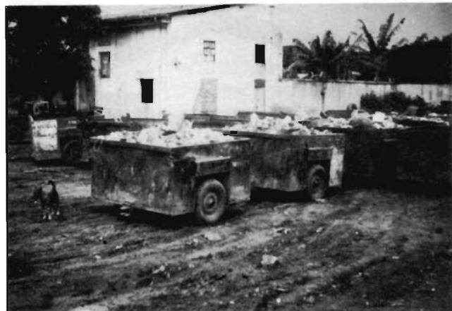
*Troletes, rebocados por trator e depois descarregados nos coletores especiais, pelo mesmo dispositivo de basculamento dos containers, s o a solu o para a coleta em ruas inacess veis aos caminh es, em Cali, Col mbia.*
