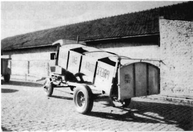
*Carroção metálico de 3,5 m<sup>3</sup> de capacidade, com cobertura, rodas de pneus, boleia, freio e descarga por basculamento por rosca sem fim, usado em São Paulo até 1968.*
