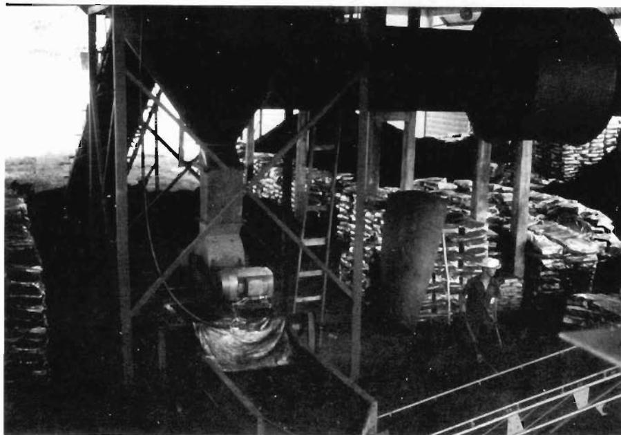
FOTO 21 - Trocador de calor para secagem, moinho e peneira para ensacamento de composto em São José dos Campos, 1980.
