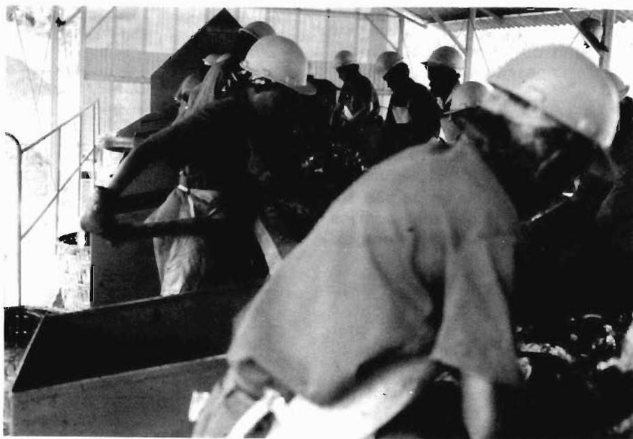
FOTO 1 - Esteira de triagem com espaço para doze operários, vendo-se o "chute" para lançamento dos selecionados em sacos. Cornélio Procópio 1986.
