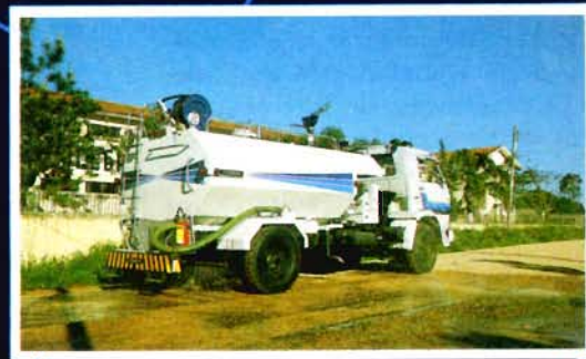
Barra de irrigação por pressão ou gravidade, ocupando toda a largura do veículo.
