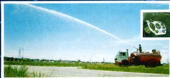
Canhão monitor (vazão de 750 GPM), com movimentos horizontais e verticais.
