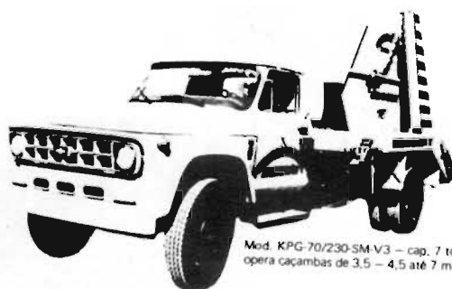
Mod. KPG — 70/230-SM-V3 — cap. 7 ton. caçambas estacionárias KABI mod. KEDLU 230/70-5-CT
