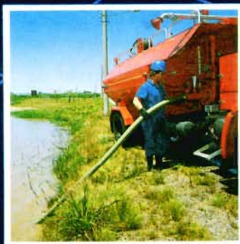
Reabastecimento em tanques abertos ou hidrantes.
