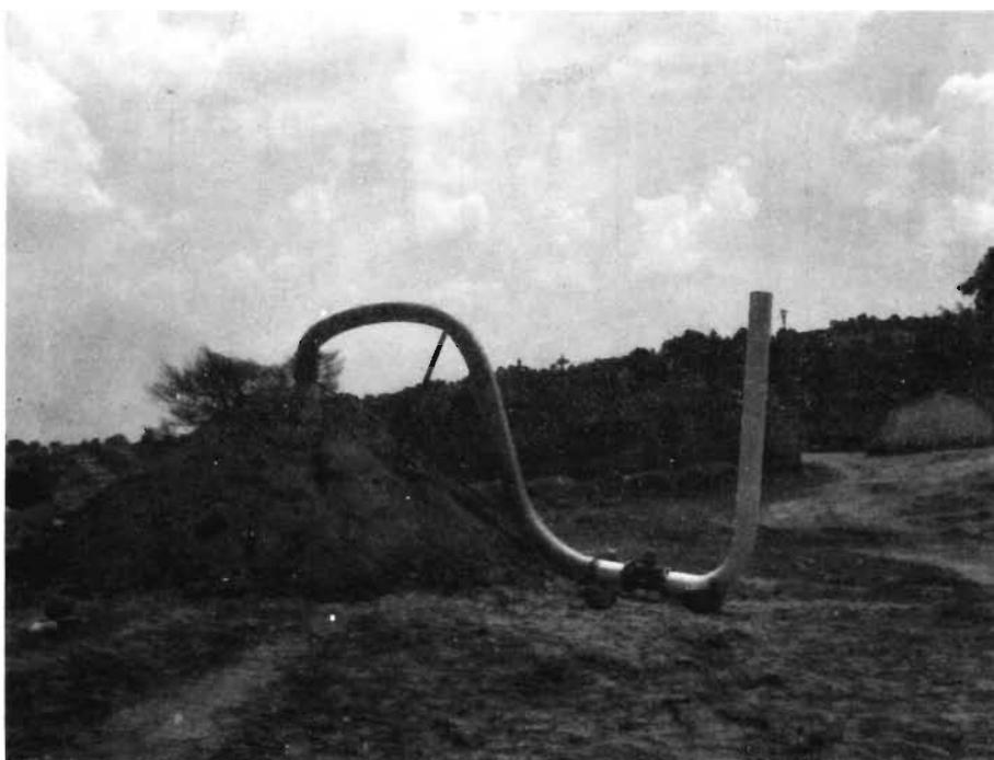
Equipamento para medir a vazão dos drenos de gás nos aterros sanitários
