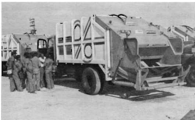
Esta fotografia mostra o dispositivo hidráulico para contenedores e o treinamento da equipe na utilização da caçamba compactadora.
