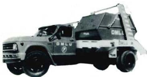
Mod. KPG-70/230-SH para 7 m<sup>3</sup> com sapatas hidráulicas, fornecido para a Prefeitura de Porto Alegre - RGS.
