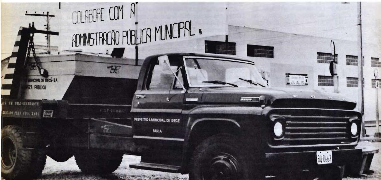
Vista dianteira/lateral do Poli-guindaste KPC-50/160-SM para 5 ton com caçamba estacionária KABI mod. KHS-160/35-5-CT para 5 m<sup>3</sup> do tipo fechado, próprias para resíduos em geral.
